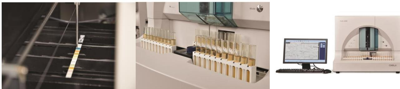
Гибридный анализатор мочи DIRUI **FUS-2000** является полностью автоматизированной системой анализа мочи, позволяющий проводить общий анализ мочи, а также анализ ее форменных элементов и диагностику с использованием единственного образца. Анализатор мочи **FUS-2000** обладает высокой производительностью, при этом он прост в обслуживании и имеет компактный дизайн «2 в 1».
