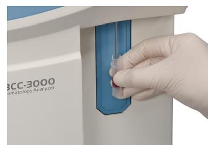
Автоматический гематологический анализатор на 21 параметр с дифференциацией лейкоцитов на 3 популяции. Надёжен благодаря используемому методу — классический кондуктометрический метод в сочетании с современной программой математической обработки. Рекомендуется для применения в небольших лабораториях.
